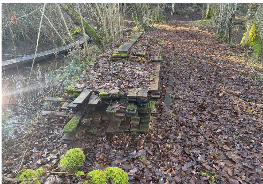
Vue sur le tas de planches de bardage (surplus de l'installation de Christophe Gonnet) pouvant potentiellement être réutilisées (à 150m environ du site, stock de 100 planches environ de 3m/9cm/8mm)
